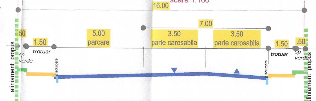
PROFIL TRANSVERSAL A*-A* DRUM NOU CREAT scara 1:100
